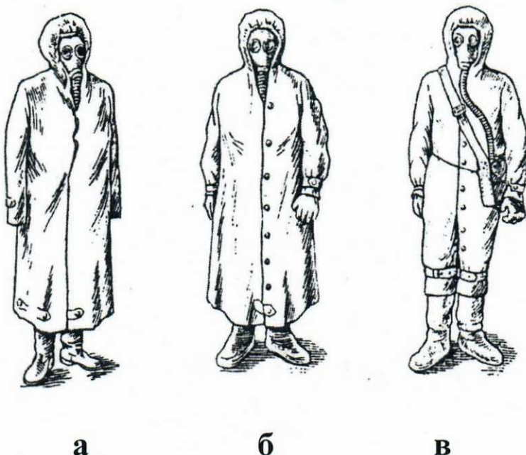
Рис. 11 Общевоинской защитный комплект в трех положениях: а - в виде накидки; б - надетым в рукава; в - в виде комбинезона
