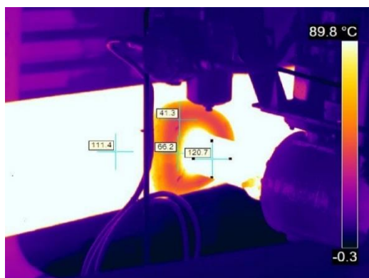
Рис. 3. Результаты теплового контроля участка ТПО ГПА с угловым сварным соединением
