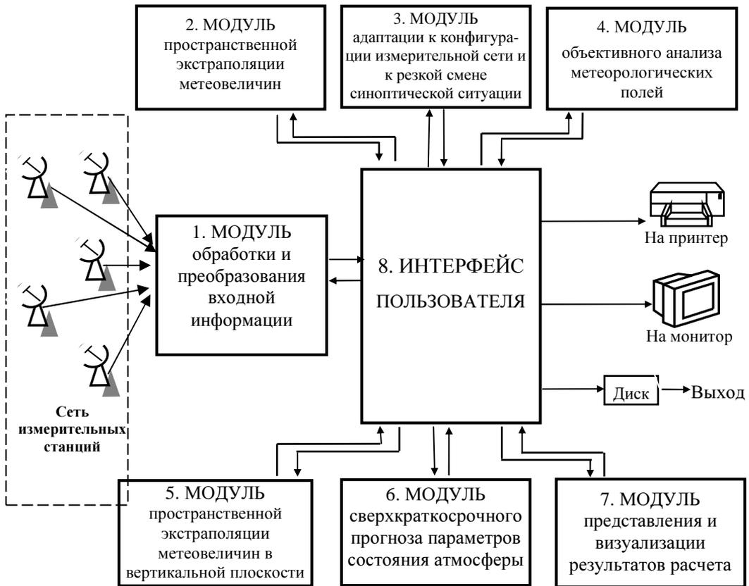
Рис. 1. Структурная схема радиофизического комплекса
