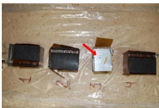
Рис. 2. Разобранный КС-110 (след пробоя на первой секции третьего пакета)
