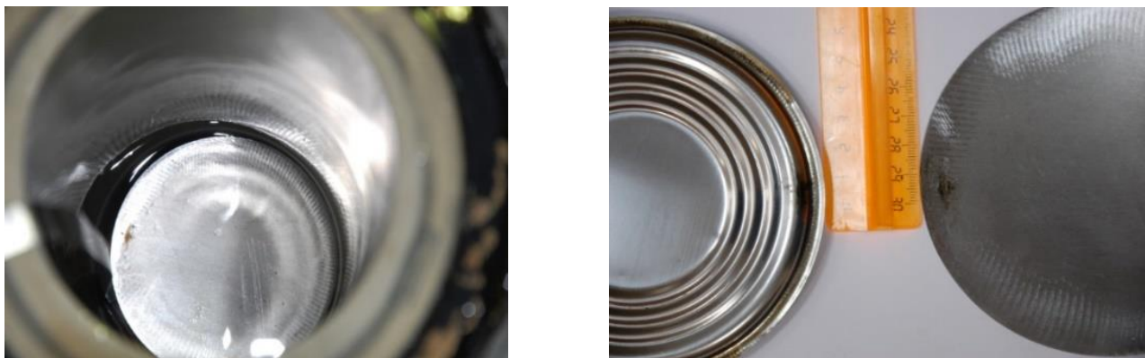
Рис. 5. След «подгара» между нижней мембранной коробкой и металлической крышкой
