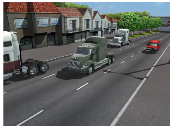
Рис. 3. Тренажер диспетчера сортировочной горки в г. Ярославле (слева). Сцена из компьютерного автотренажера с генерируемыми компьютером автомобилями, динамической системой отображения теней, работающими алгоритмами уменьшения детализации объекта при удалении от наблюдателя и др (справа)
