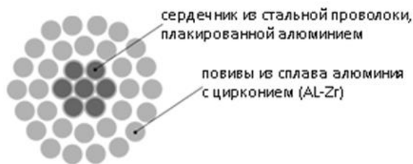
Рис. 9. Структура провода марки АСПТ
