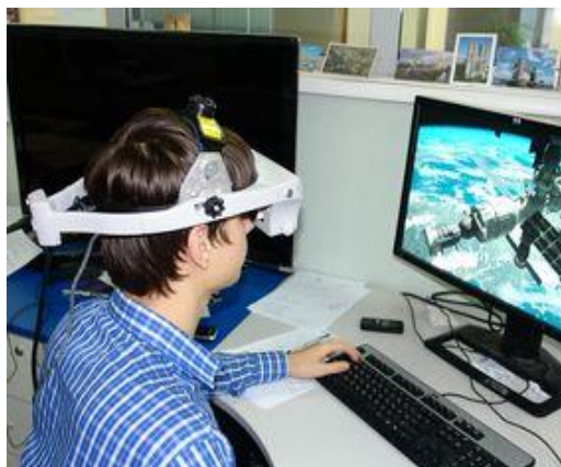
Рис. 9. Лабораторный образец бифокального стереоскопического наголовного дисплея
