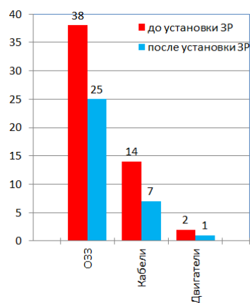
Рис. 5. Повреждаемость в сети 6 кВ мощной ТЭЦ (а) и фотографии установленных на ОРУ двух резисторов 300 Ом (б)
