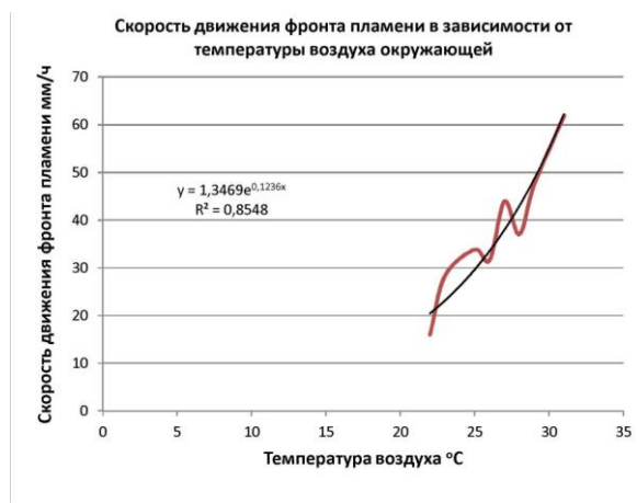
Рис. 6. График скорости движения фронта пламени в зависимости от температуры окружающего воздуха
