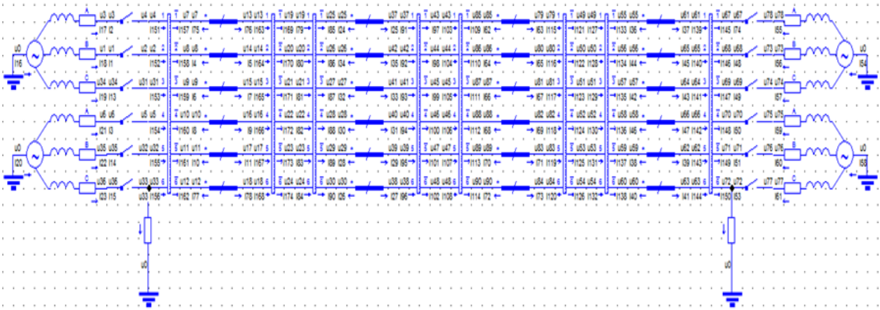
Рис. 1. Математическая модель несимметричной 6-проводной ЛЭП в системе с модальными волновыми каналами
