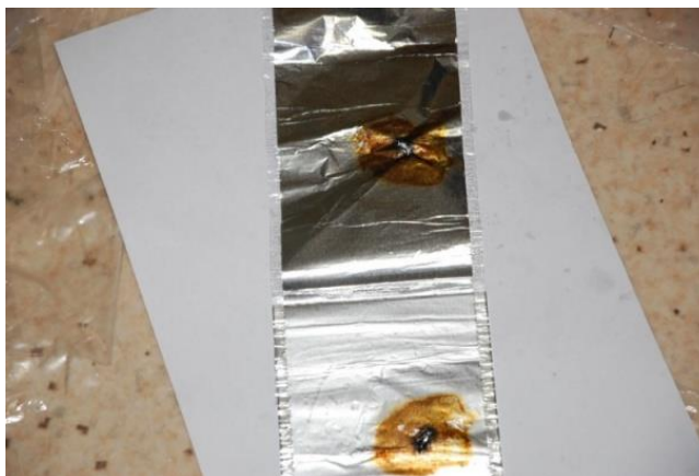
Рис. 3. Следы пробоя между обкладками первой секции третьего пакета
