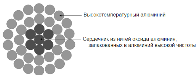
Рис. 6. Структура провода ACCR компании «ЗМ», США
