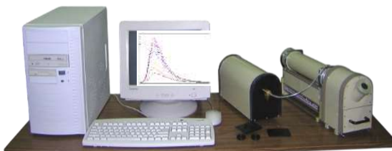
Рис. 1. Установка КЛАВИ ( К атодо Л юминесцентный А нализатор В еществ И мпульсный)
