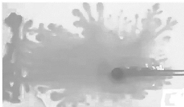
Рис. 2. Фотография вытеснения жидкости между пластинами
