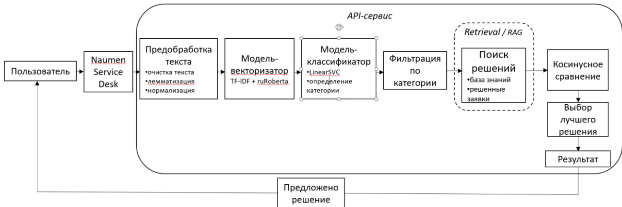
Архитектура системы автоматической обработки заявок
