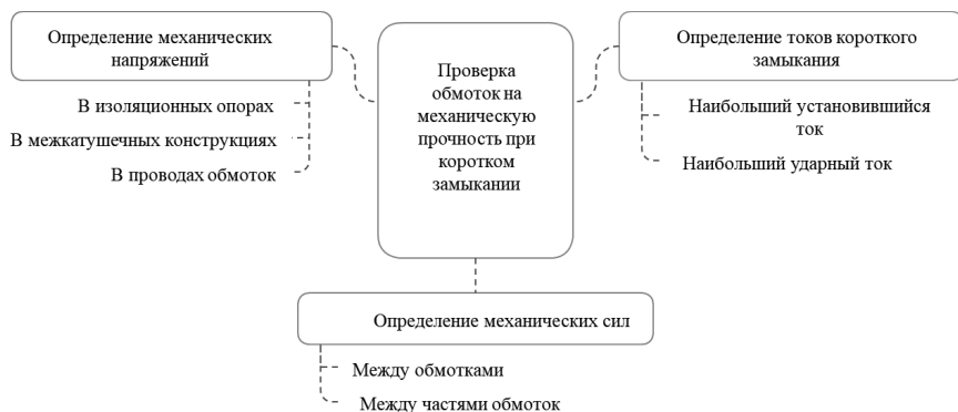
Рис. 1. Алгоритм проверки обмоток на механическую прочность
