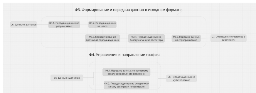
Рис. 3. Ф3. Формирование и передача данных в исходном формате; Ф4. Управление и направление трафика
