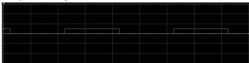
Рис. 6. Выходные сигналы регистра сдвига
