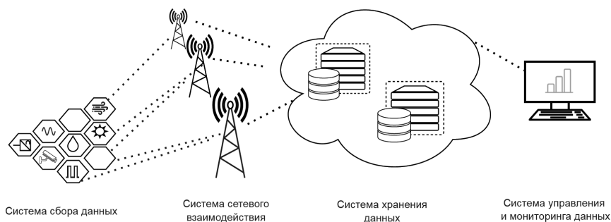
Рис. 1. Структура системы интернета вещей [1, с. 10]
