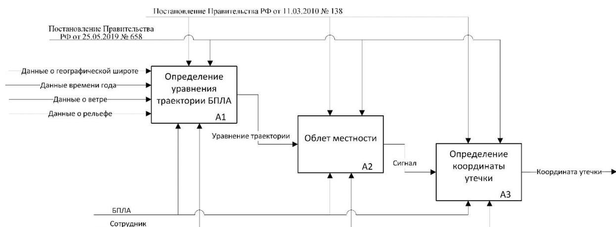
Рис. 2. Диаграмма декомпозиции блока А0 функциональной модели
