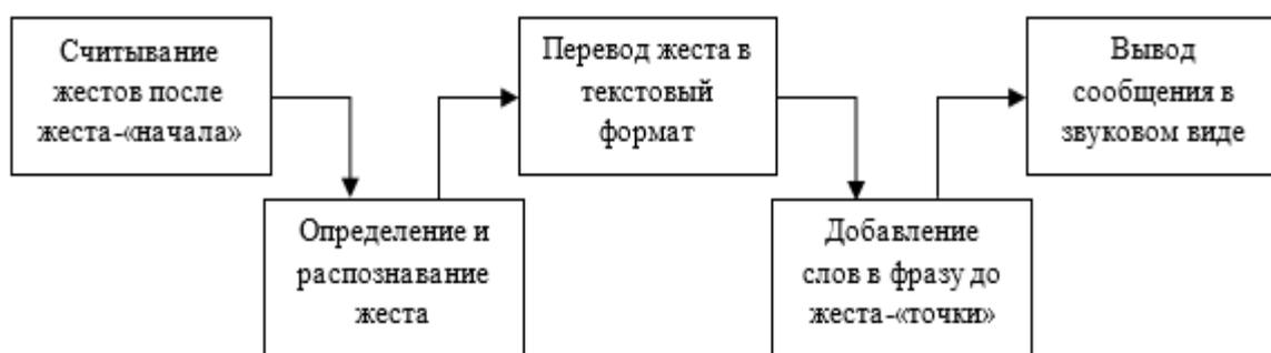
**Рис. 1. Алгоритм работы преобразователя жестовой фразы в звуковой формат**
