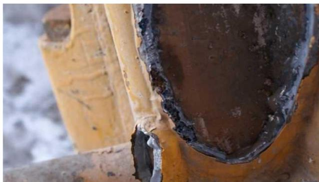
**Рис. 2. Дефект сварного шва**
