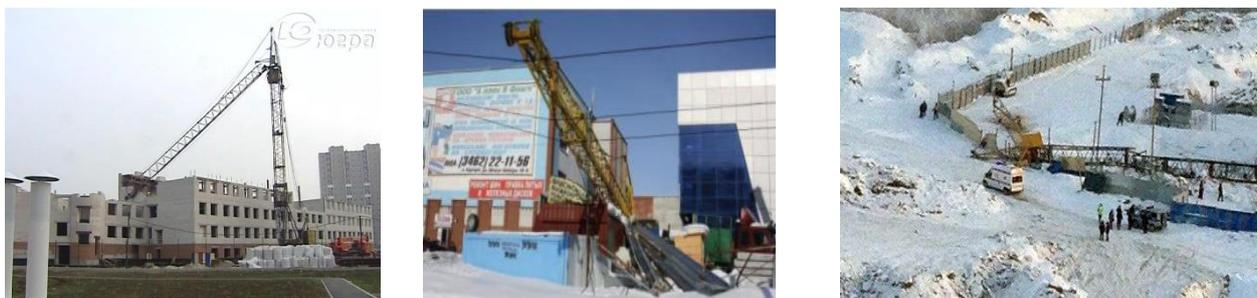
**Рис. 1. Примеры аварий башенных кранов в г. Сургуте**
